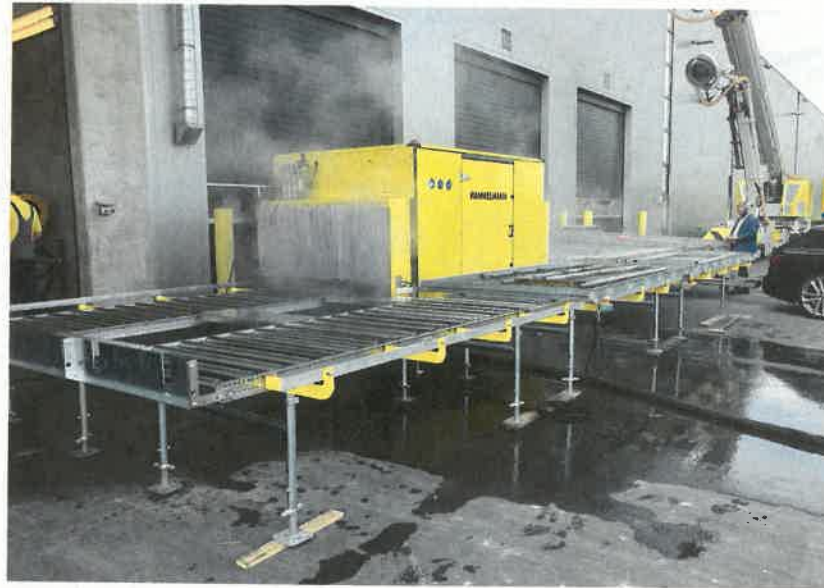
Waschstraße für Gerüste.
